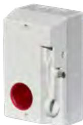
Un inter pompiers est un dispositif obligatoire permettant aux pompiers de couper l'alimentation de votre enseigne lumineuse en cas d'intervention. Il doit être placé entre l'enseigne et votre tableau électrique, à proximité de l'enseigne, non accessible à portée de main, mais doit pouvoir être atteint, c'est à dire à une hauteur de 3m maximum.
