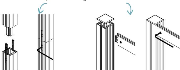
Les profilés Linear se manchonnent grâce à un système de connecteurs déjà intégré au profilé.
