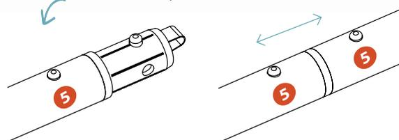
Assemblage des sections 50 mm
