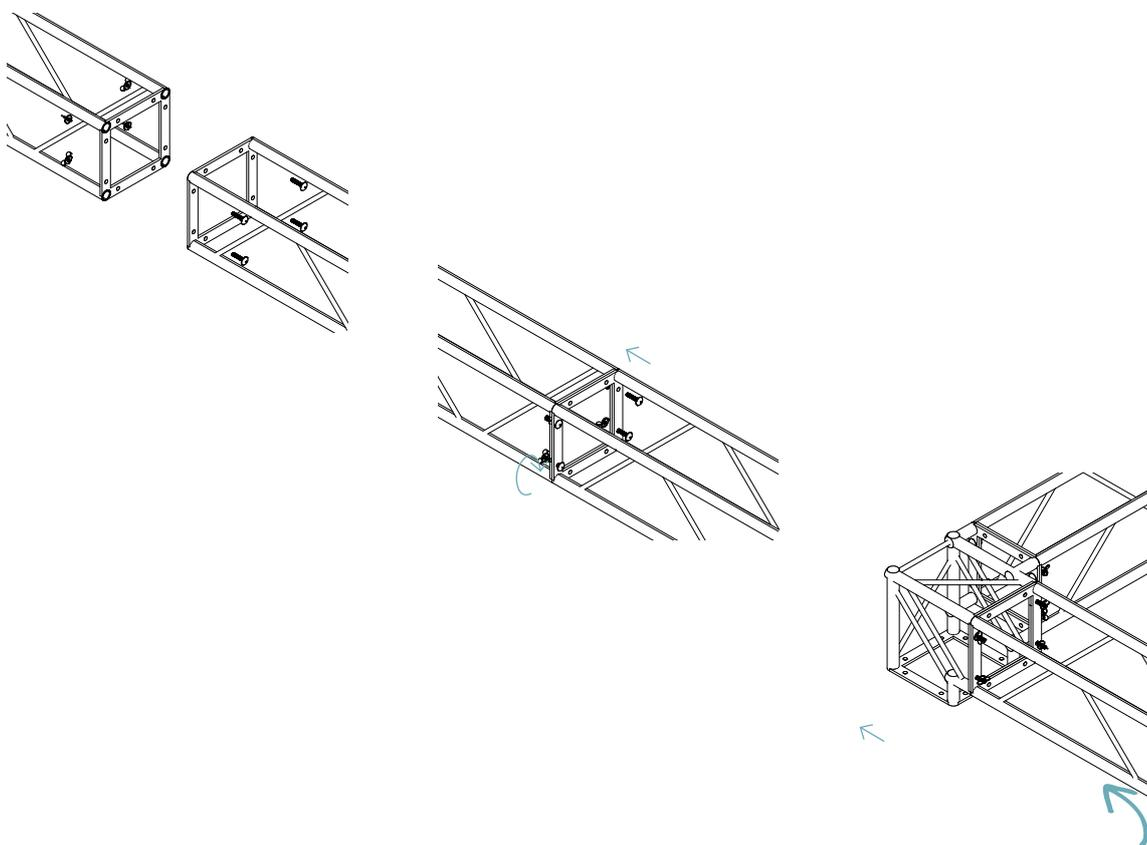
Les différentes sections s'assemblent facilement
