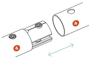
Verrouillage des sections par clé Allen
